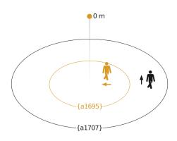
Hauteur d'instal lation: 0,00 m – 0,00 m Orange: sens de passage radial Noir: sens de passage tangentiel
